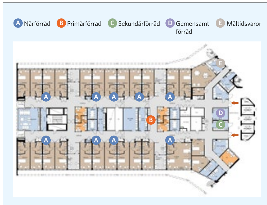
FIGUR 7. Vinge i huvudbyggnaden på Helsingborgs sjukhus med förrådstyper inlagda
