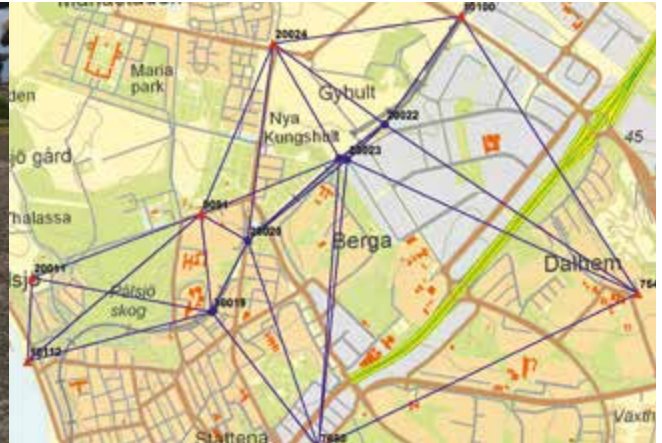
Förtätning av RIX 95 med primärnät för järnvägsmätning.
